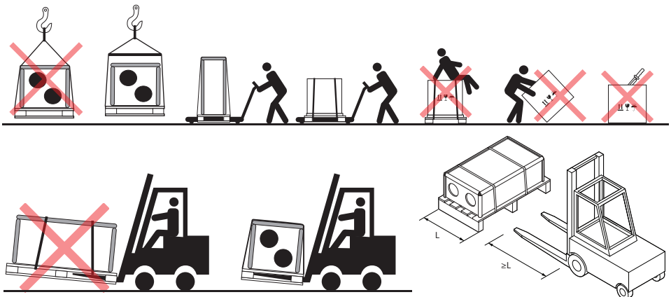
4 pav. Transportavimo kranu, autokrautuvu ir technologiniu vežimėliu pavyzdžiai
